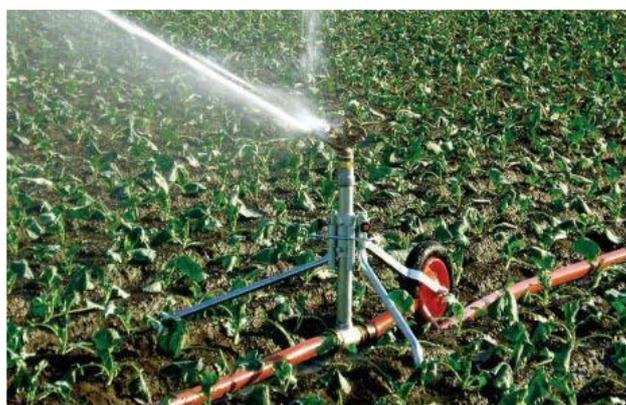
圖3-25 大型灑水器85型安裝於獨輪車示意
