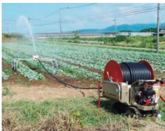
圖3-24 田間滾輪灌溉車運行示意
