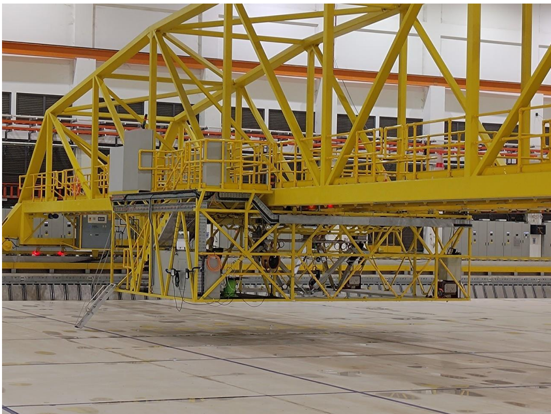
圖 7 TCOMS 深海試驗水槽設備：主拖車與子拖車
