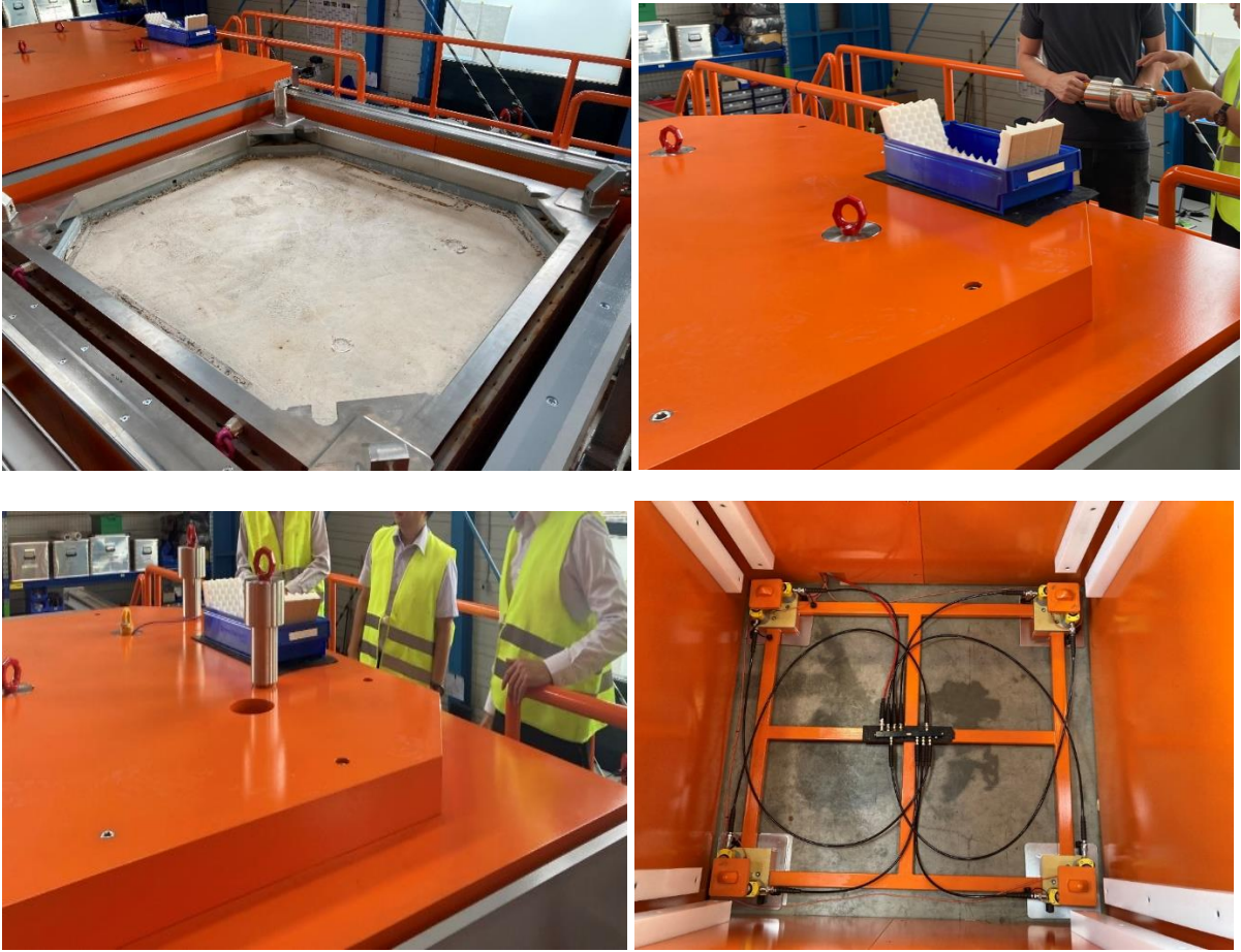
圖8 工作站上操作灌漿監視器並量測T容器重量與重心
