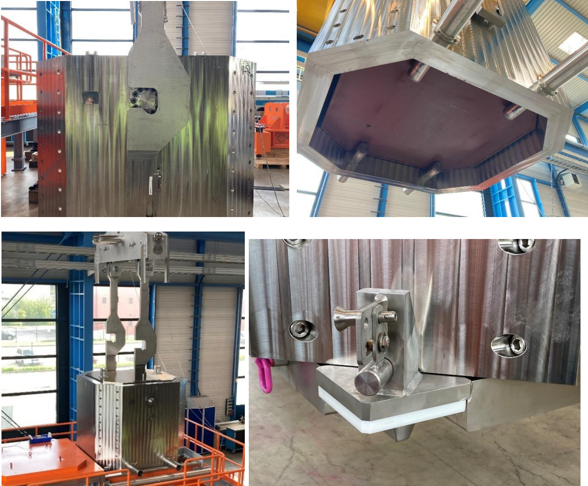
圖7 吊運屏蔽鐘(含內提籃)至工作站上再將內提籃向下吊運至T4容器內
