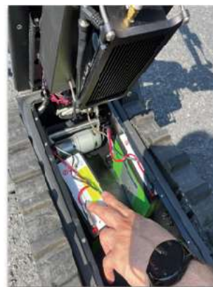
機器人電池亦改為公版 (一般鋰電池即可)
