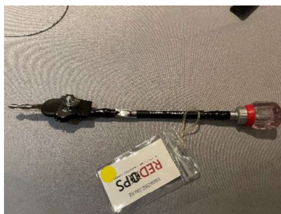
螺絲頭連接鑰匙，以遙控開啟門鎖
