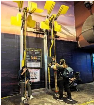
滑輪裝置，觀眾以手抓住繩子往下拉，試試能否將自己拉起來
