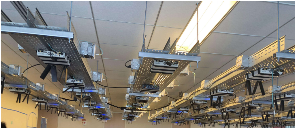
圖 10、基於 O-RAN 之無線電網格室內測試平台
