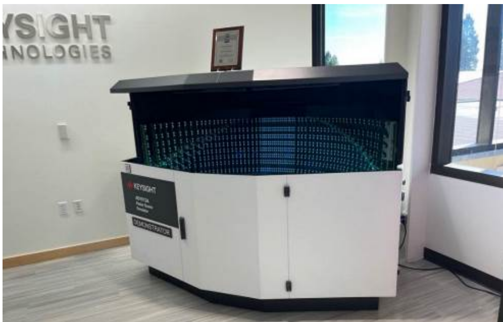
圖 25、自駕車用雷達驗證系統
