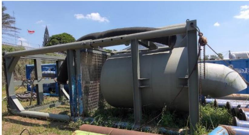
圖 12、空氣鑽井所需空氣/泥漿分離器(使用時須直立起來)
