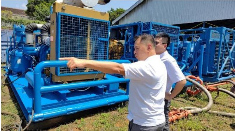
圖 11、了解空氣鑽井所需空壓機及增壓機等設備及管線走向
