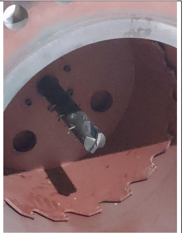
4、 附錄 3-3：防止鑽破的管線鐵片掉入管線內部的機械構造
