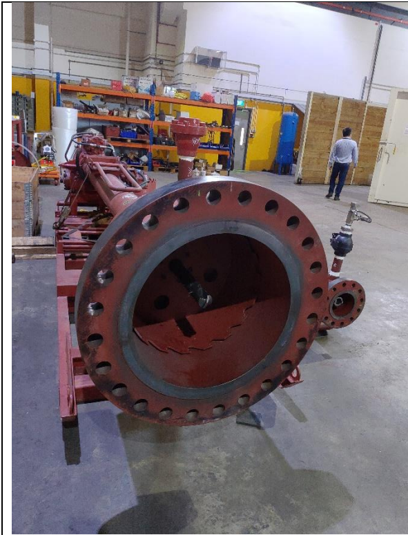
4、 附錄 3-3：防止鑽破的管線鐵片掉入管線內部的機械構造
