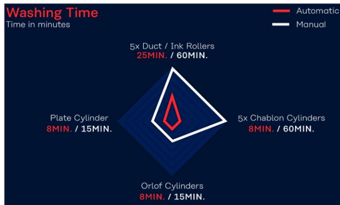
圖(28) 控制台裝置清洗即時資訊
