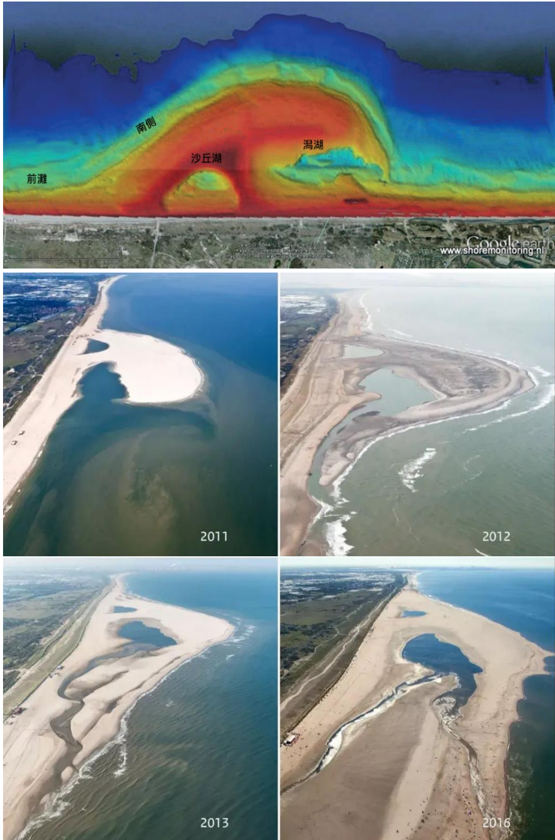
圖 2 Sand Motor 的發展：2012 年，沙洲和水道的形成 2013 年；水道的延伸和對稱形狀的發展 2016 年；形成海與潟湖之間的新連接處。
