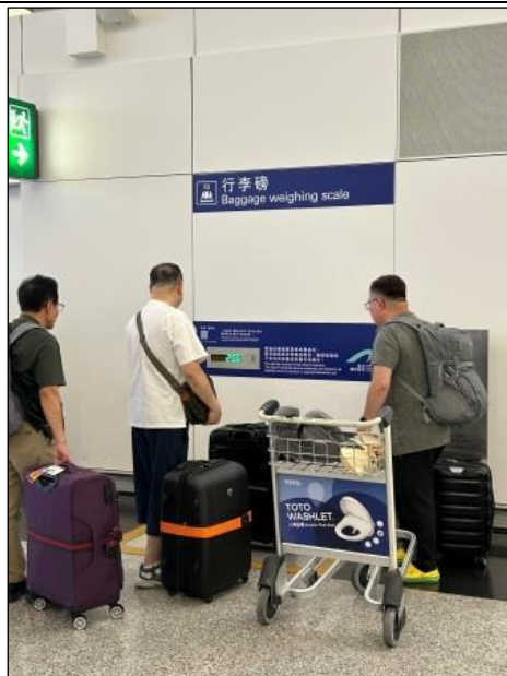
2.4 報到櫃台旁設置與地面齊平的行李秤，旅客將行李推上秤即可秤量
