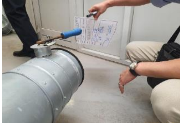
圖 5-37 確認 PCA 排風作動正常
