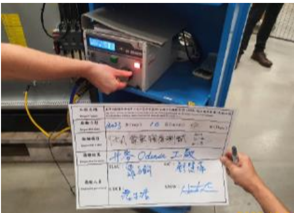
圖 5-26 電氣強度測試—使輸入端子短路，在端子和框架之間施加 2.0 kV 電壓 1 分鐘
