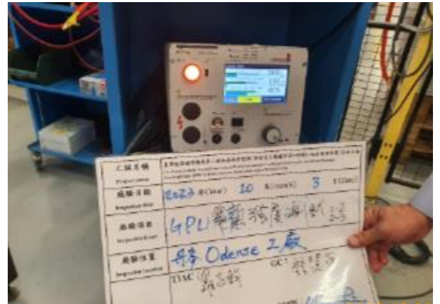
圖 5-53 電氣強度測試(輸入端子與框架短路，在輸出端子和框架之間施加 2.0 kV 電壓 1 分鐘)
