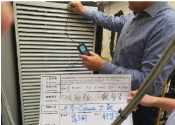
圖 5-24 檢查膜厚，平均膜厚 291 \mu m
