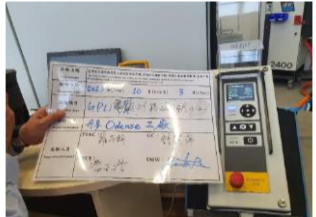
圖 5-53 電氣強度測試(輸入端子與框架短路，在輸出端子和框架之間施加 2.0 kV 電壓 1 分鐘)
