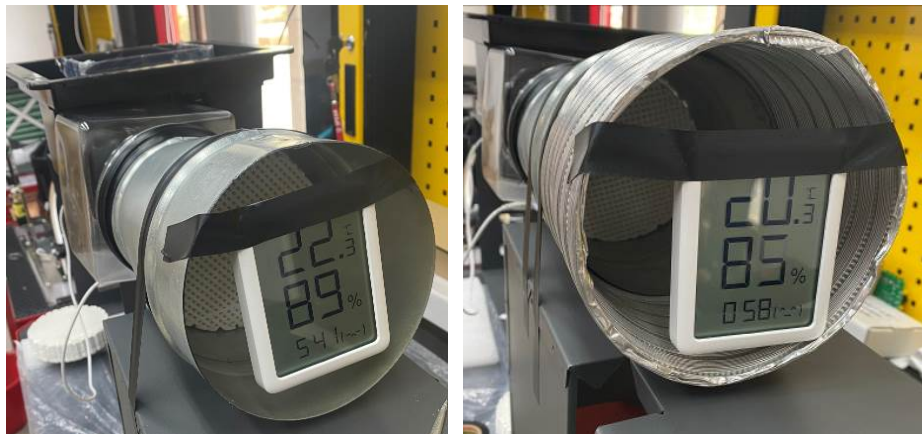
圖12、自製積層製造除濕潔淨轉輪元件裝設於測試機台及測試狀況
