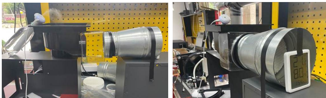
圖14、循環吸附材料移除水氣自行組裝測試設備(抽風式)
