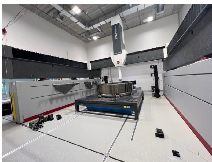
圖四、大型齒輪量測標準件及 CMM
