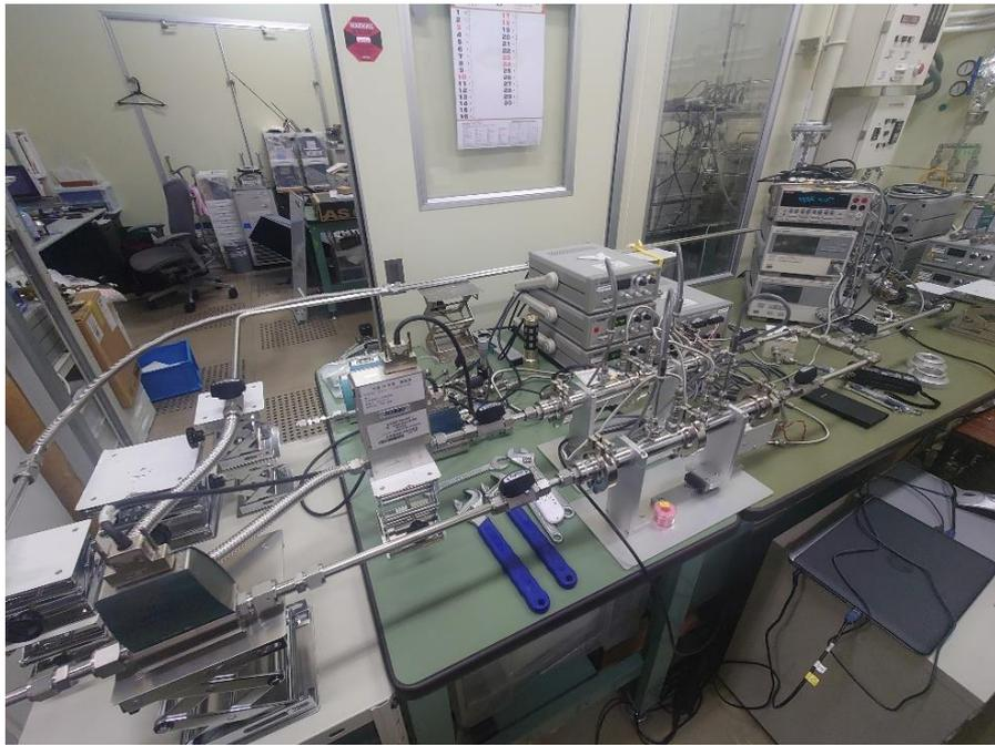
圖 18 小流量原級氣體流量標準系統現場實際照片
