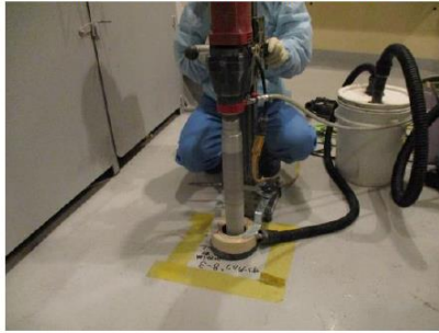
圖 47 美濱核電廠反應器壓力容器外部人工取樣情形 (圖片來源 ANDES 訓練資料)
