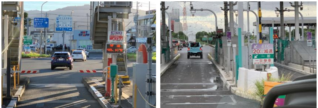
圖3-6-3 ETC車道仍設有柵欄(確認繳費後柵欄才升起)
