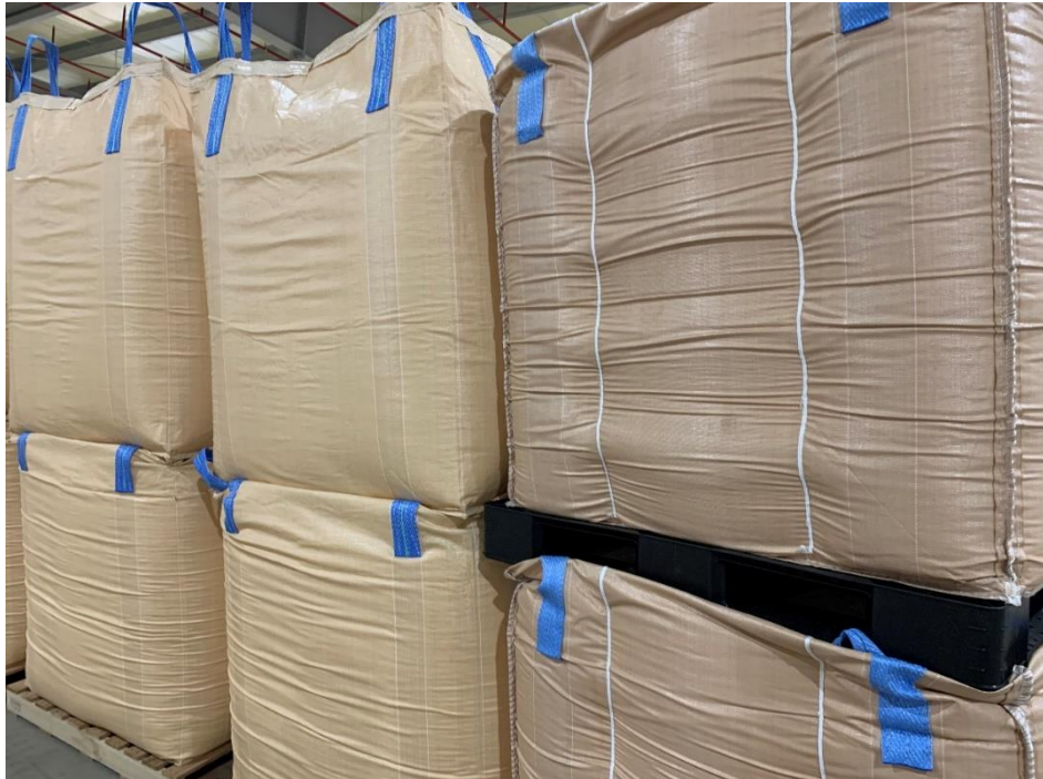
圖 7、外銷包裝強度依買方國家規定要求有不同強度(縫線)
