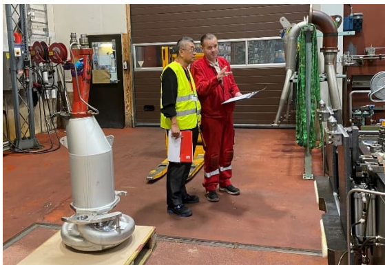
貨油泵測試前準備(液壓泵添加液壓油)
