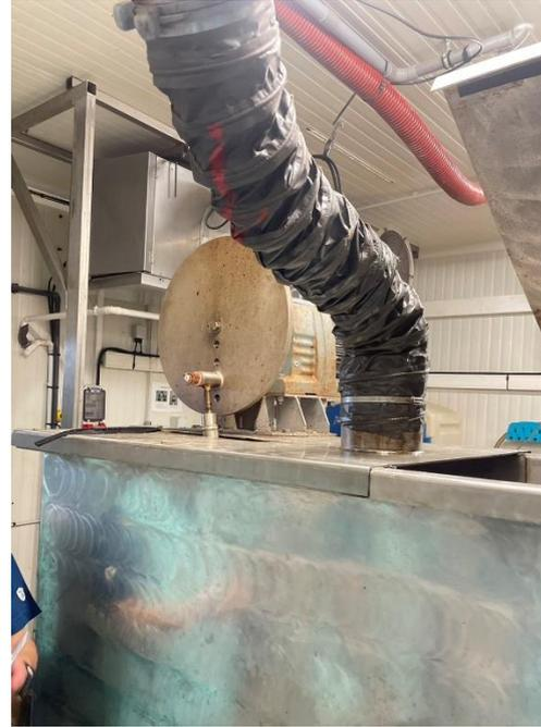
本項裝置用於測試油的成分及其化學變化，模擬極地圈及熱帶雨林的氣候及海洋洋流，可每天或每星期觀察油在水中（揮發、沉積、溶解、漂浮）其密度、黏度的變化，並分析是否有生物降解的作用，相關報告可提供給公私部門，制訂其應變計畫參考或做為訓練材料，並揭露於 CEDRE 網站。
