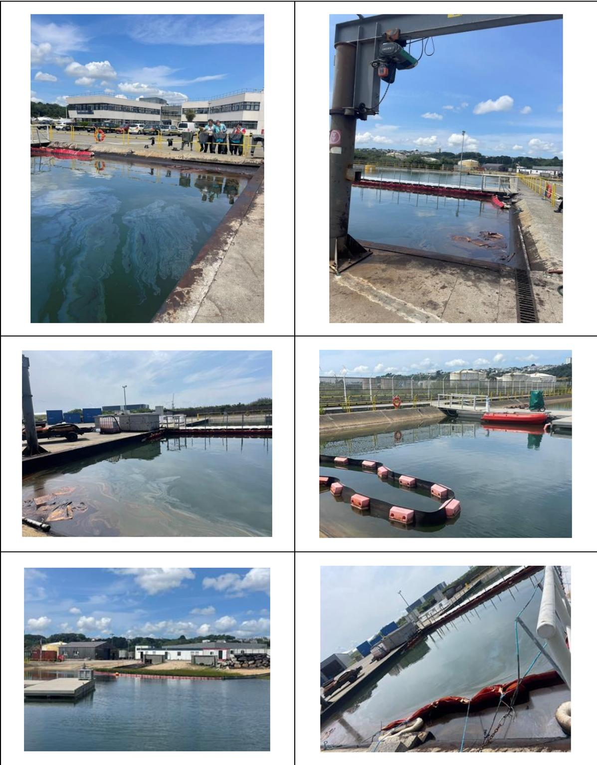
CEDRE 設有室外模擬油污染場地，可作為訓練人員施放攔油索、使用吸油棉、機械回收油污、使用高壓洗機沖洗岩石或火災救災應變及提供油在自然環境下觀察每天油性質變化的訓練場所。
