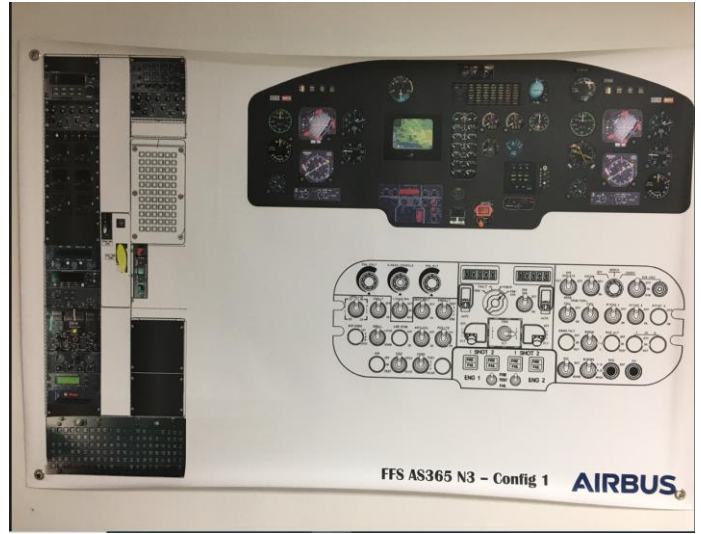
圖五、模擬機教室 AS365N3 儀表照
