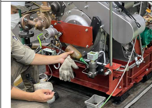
圖 20.燃油洩漏測試
