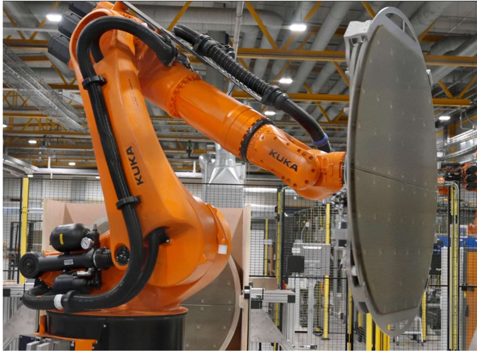
圖 8. Nel Hydrogen 赫羅亞廠內前處理產線段採用KUKA機械手臂實現全自動氫電解槽生產方案(因廠內未開放拍照，故採用Nel提供照片)
