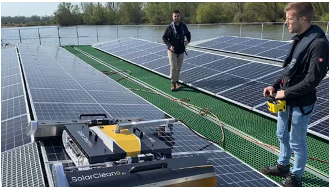
圖 40. SolarDuck離岸光電模組清潔示意圖
