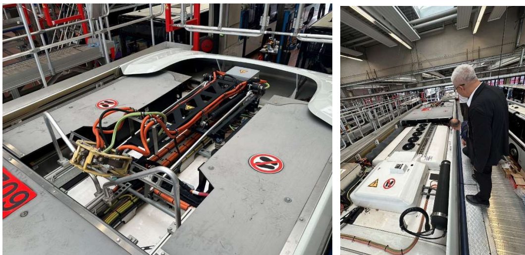
圖 58. 參訪團考察於科隆KVB公車運維總站之電動巴士車頂上升型集電弓裝置
