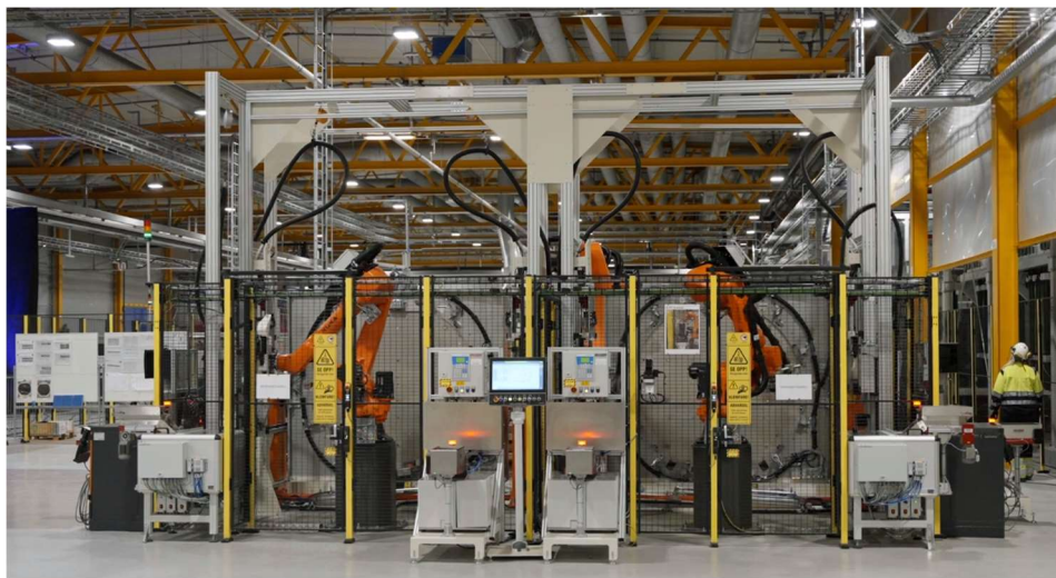
圖 7. Nel Hydrogen 赫羅亞場內全自動氫電解槽生產線，前處理產線段照片(因廠內未開放拍照，故採用Nel提供照片)
