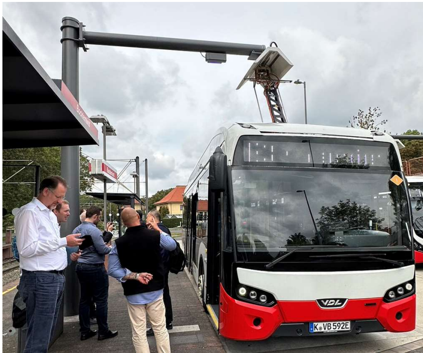
圖 61. 參訪團搭乘電動巴士至科隆Bocklemünd公車站實際體驗站燈柱式集電弓充電操作
