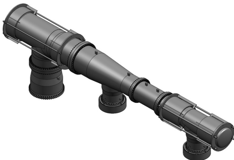
圖 39 低壓蒸汽跨管
