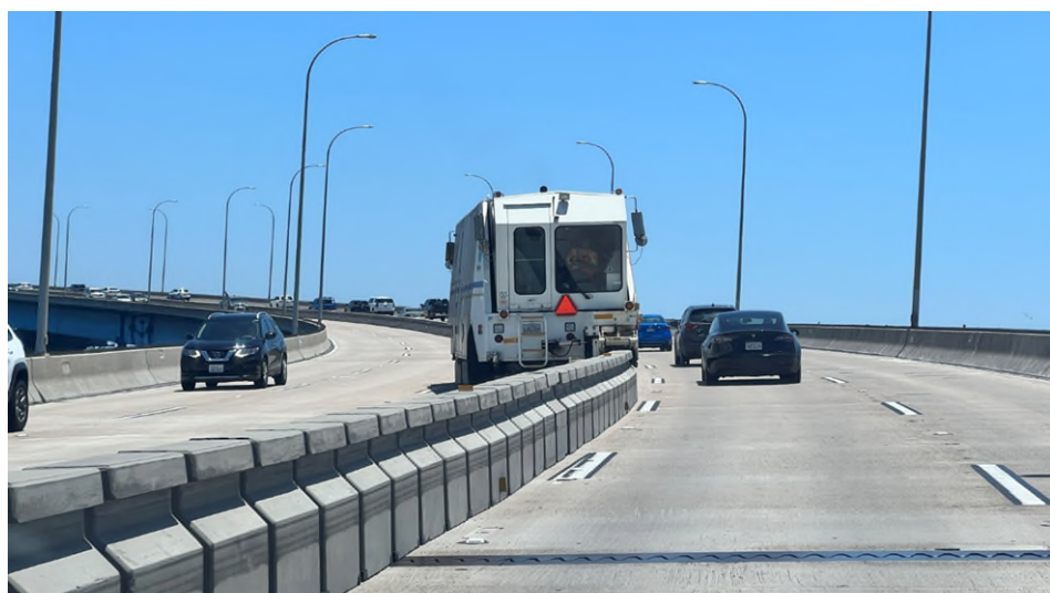
圖 64 Coronado Bridge 設置活動式中央分隔島，可快速移動護欄位置，調整雙向車道數
