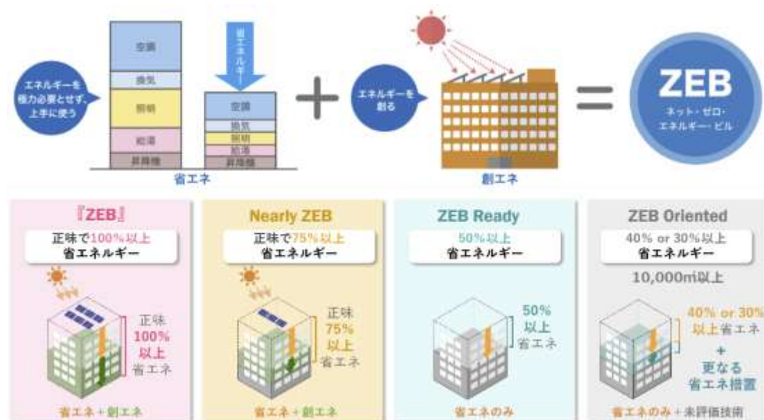
圖 49 ZEB 分級解說 (來源：大成建設網站)
