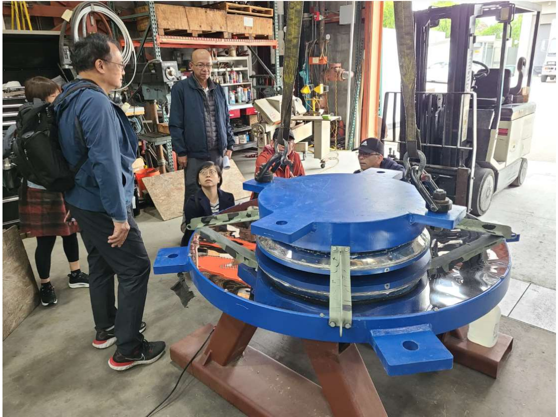
隔震器安裝至測試機前準備
