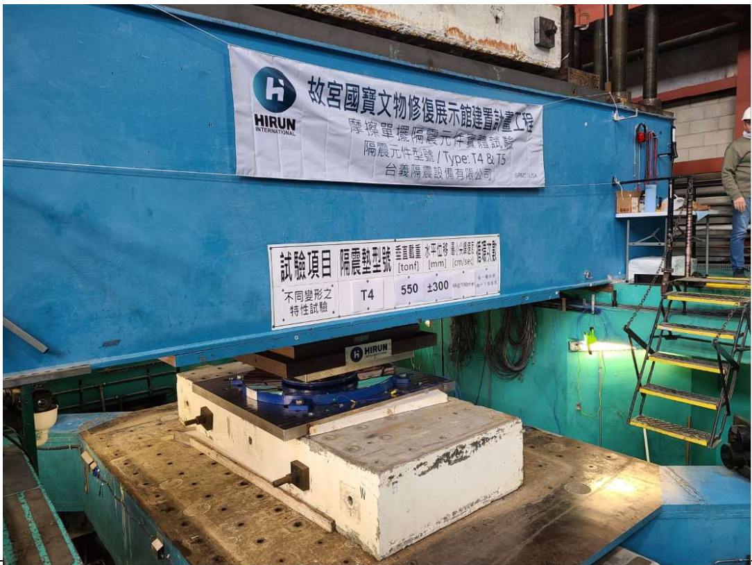
隔震器安裝至測試機，進行高速位移測試
