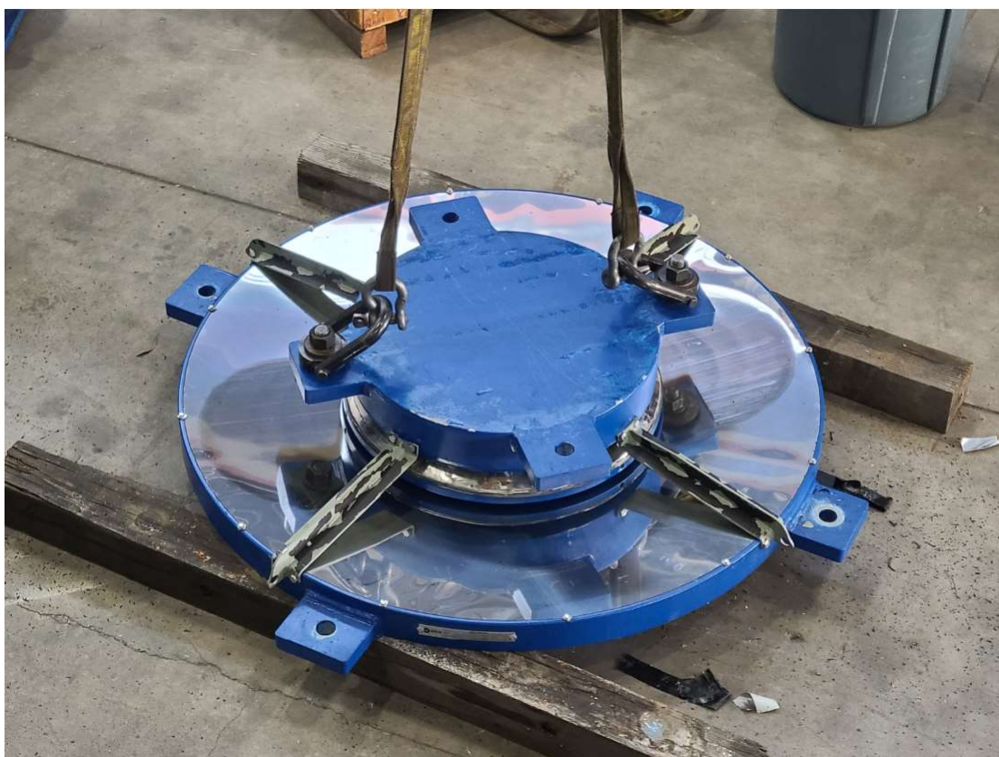
隔震器測試完後, 拆卸出測試機
