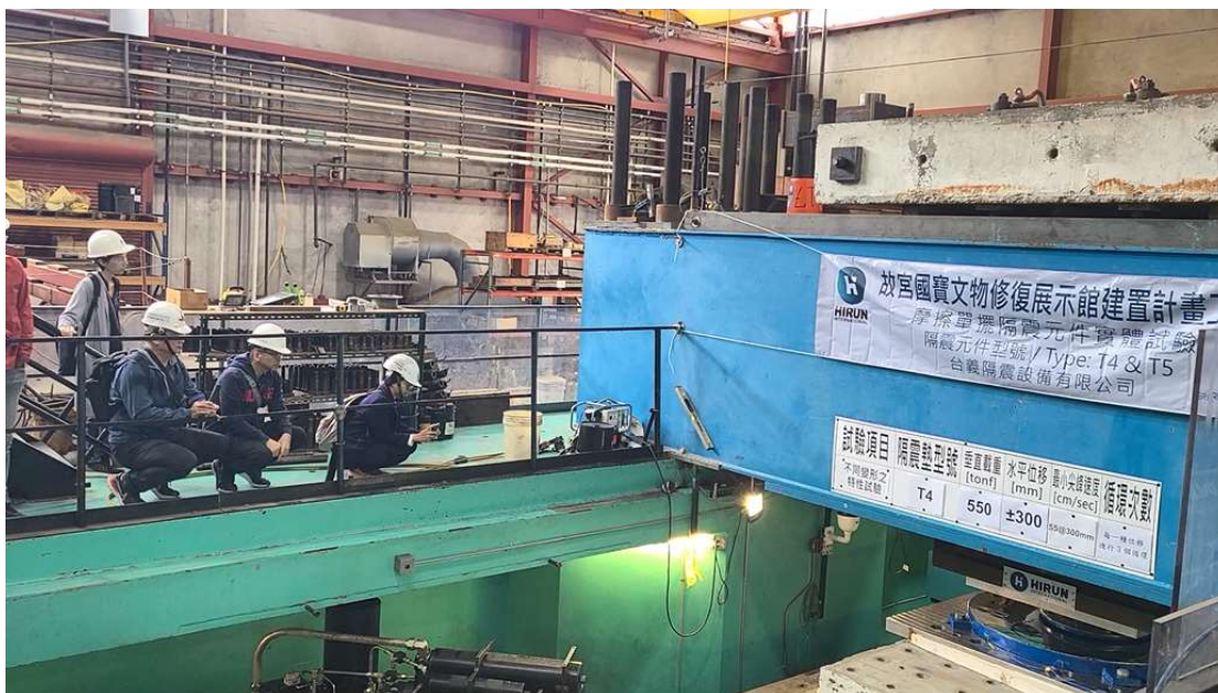
隔震器進行高速位移測試時, 影片紀錄
