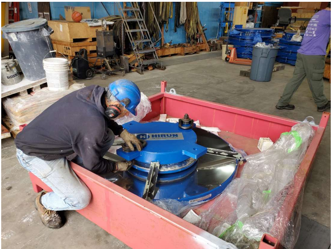
隔震器安裝至測試機前準備
