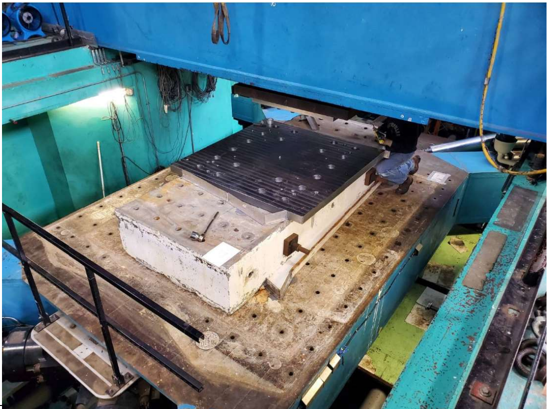
測試機與隔震器連接板準備
