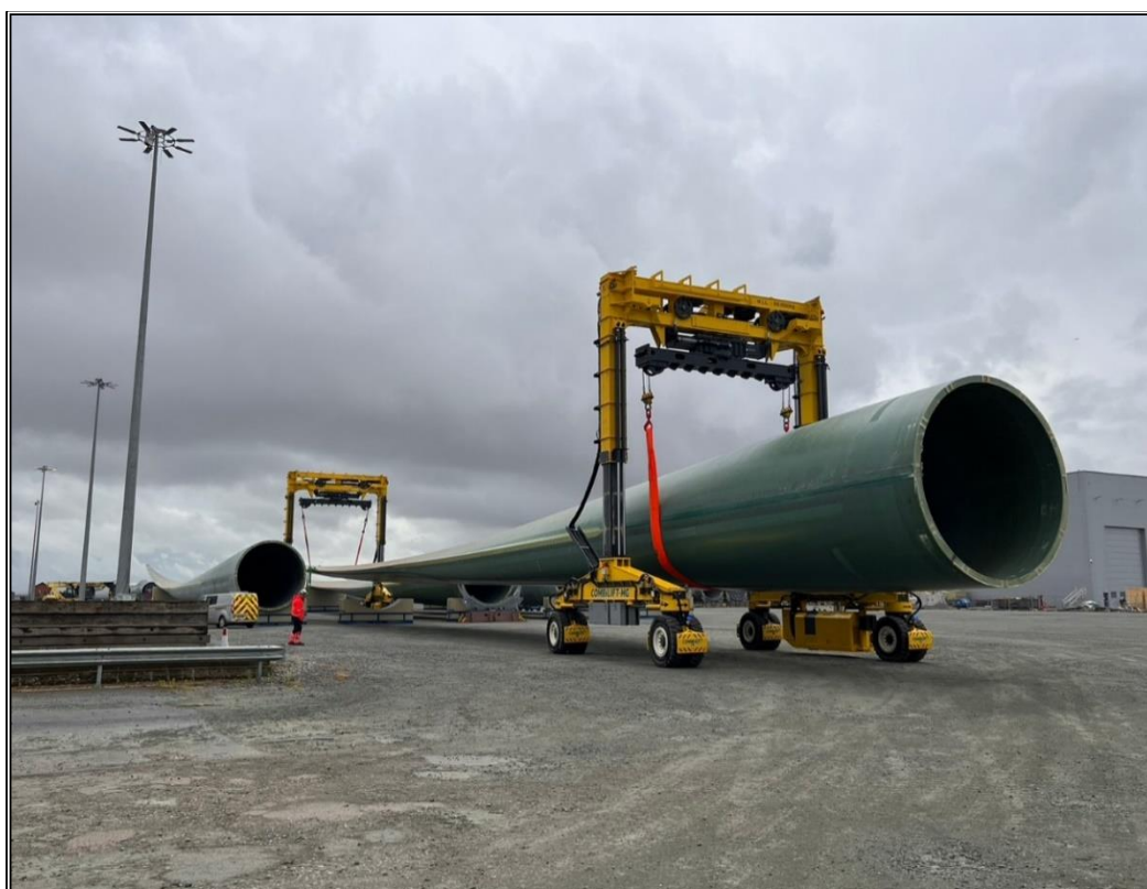
圖 11，場區內風機葉片吊掛與移動
