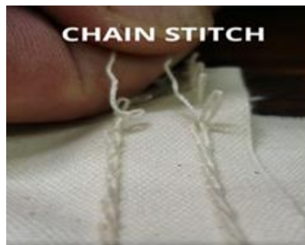
圖 3-22 (左)鏈式縫法圖示 (右)拉起線頭整個接縫線像飼料袋一樣散開
