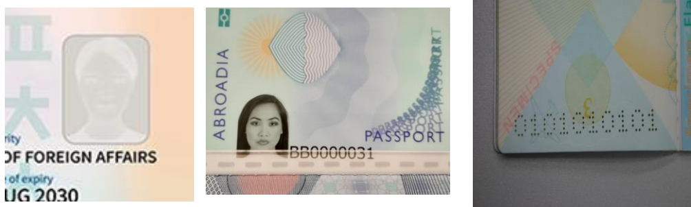
圖 3-58 雷射加工技術應用於護照防偽之各種不同物理現象
