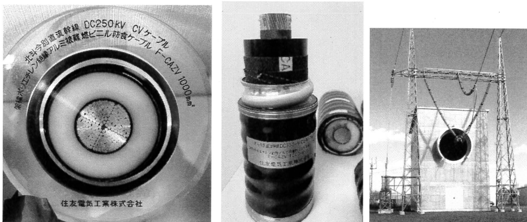
圖 18 HVDC 電纜及屋外型終端匣室
