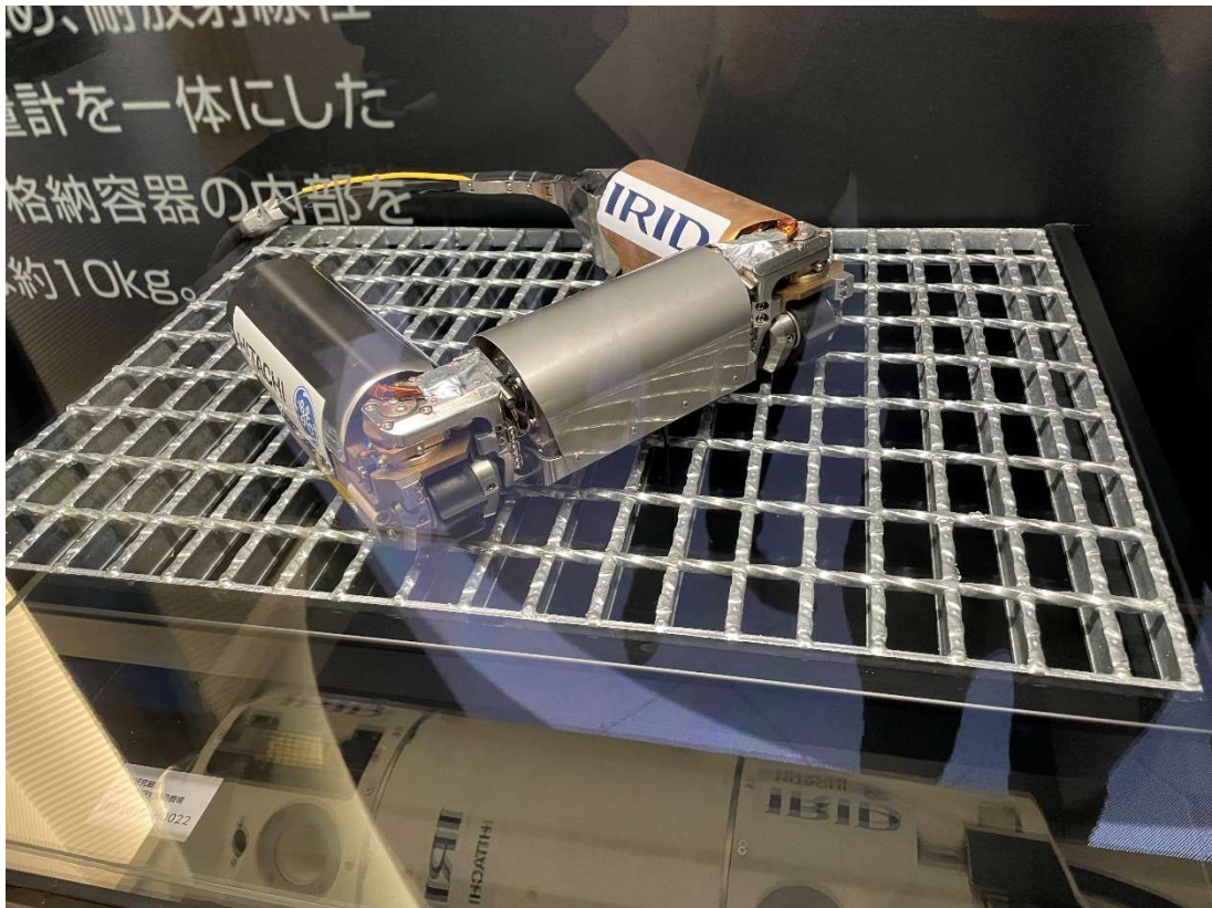
圖 6. 水下與耐高溫高輻射機械手臂
