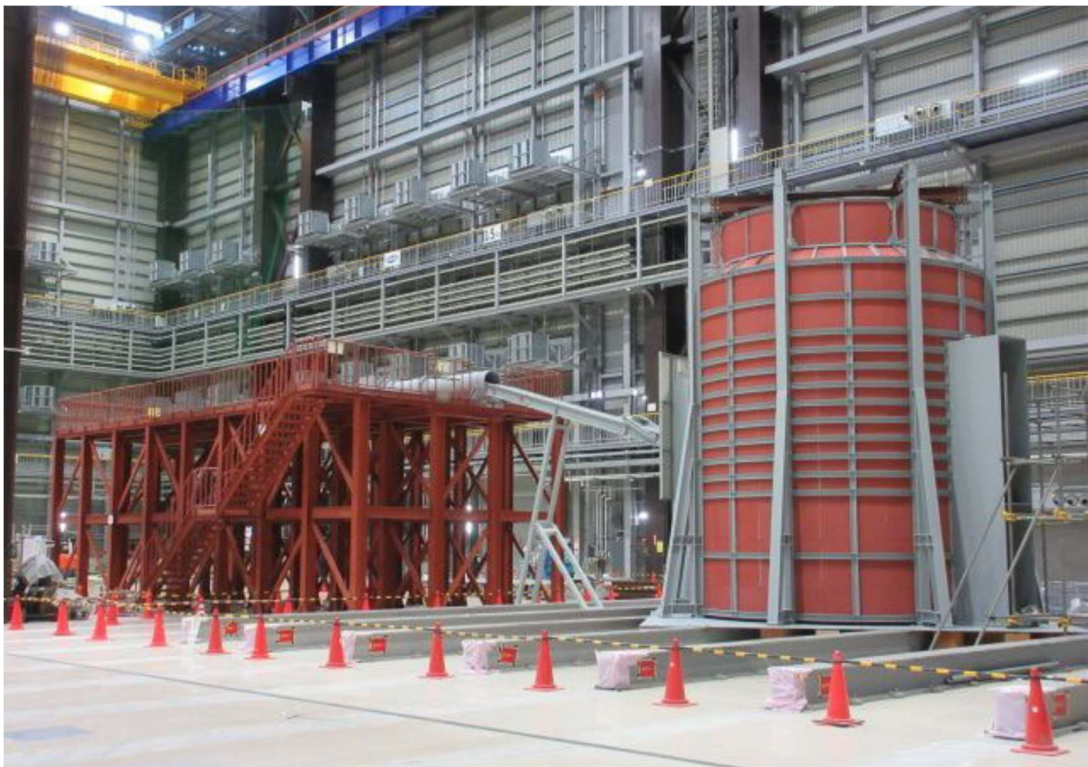
圖 7. 用以模擬機械手臂進入機組拾取燃料熔渣之一比一模型 1
