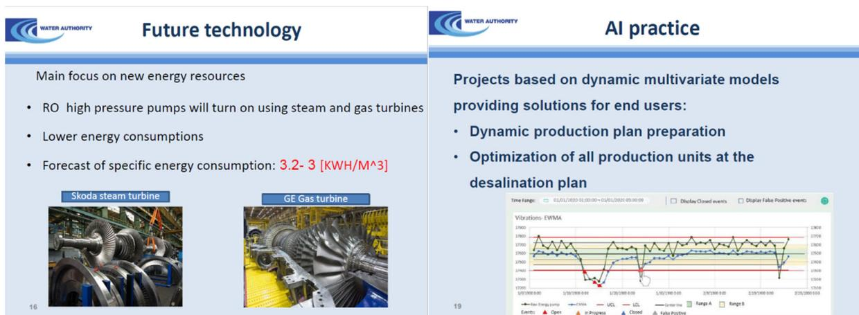
圖 3-7-8.未來發展重點在燃氣、蒸氣渦輪直推 RO 高壓泵，以及 AI 產水管理
