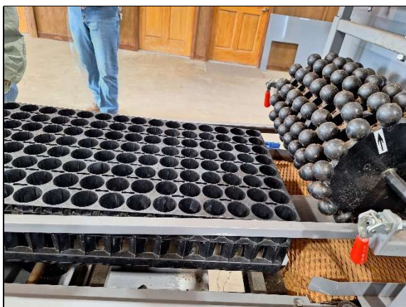
穴植管介質裝填自動化系統
