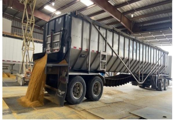
圖 15、裝卸黃豆過程，一輛約 25 噸、20~25 分鐘可卸載完畢。
