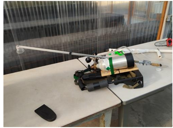
Meridian Seed Orchard 種子園自製的操作育種之工具：個別母樹花粉授粉裝置，左方前頭可以電動控制花粉噴出。
