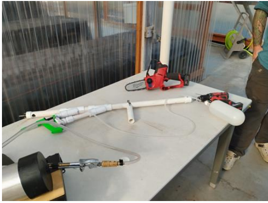
Meridian Seed Orchard 種子園自製的操作育種之工具：自動激素注射器，使用電鑽作為動力，十分客製化與創意。
