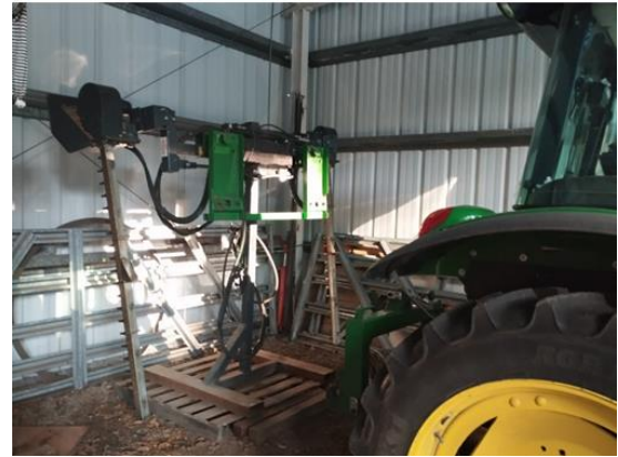
Meridian Seed Orchard 種子園大型機具設備。透過曳引機載掛不同功能的器械，圖為種子原母樹矮化修剪使用工具。
