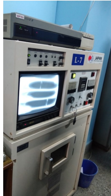
圖十六、透過 X 光機器判定種子於運輸過程有無產生碎粒，確保種子品質
