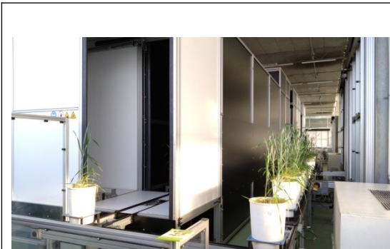
圖五、表型研究中心透過多種光譜鏡頭，拍攝植株外觀其反映其他生理狀態之光譜
