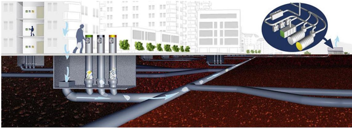
垃圾收集系統示意圖-圖片取自網路
