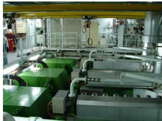
四台柴油發電機機(1460kW)，兩臺交流電動機(1650kW)，4 個橫向推進器(3 前 1 後)、柴油容量 1233m 3 、飲水容量 25m 3
