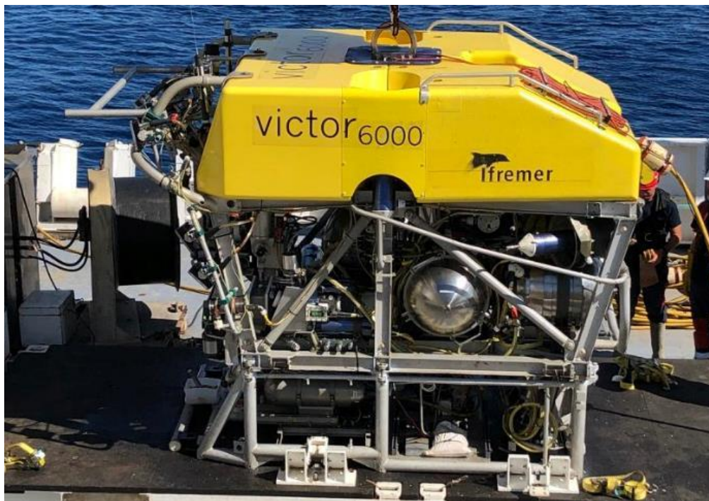
圖 11、Ifremer 自主研發的 Victor 6000 無人載具可觀測深達 6000 米，除可工作長達 15,000 小時不會疲憊外，更可攜帶高達 150 公斤的設備，除穩定抗流的深海觀測能力之外亦可進行大型岩石採樣。(Credit: Ifremer FOF website)
