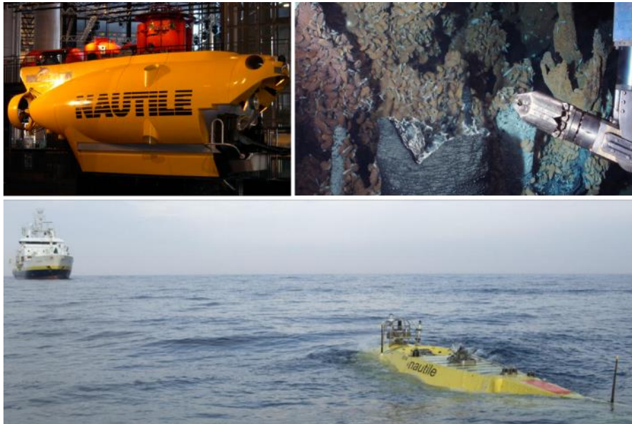
圖 10、Ifremer 自主研發的 Nautilie 載人潛艇觀察可觀測深達 6,000 米，除攝像鏡頭及兩個機械手臂外，還能搭載很多設備（水採樣器、動物抽吸器、化學分析儀），多用於研究生物多樣性和氣候變化對深海的潛在影響，以及海洋地質的觀測及採樣作業，單次下潛可達八小時，有利於了解海底季節變化並觀察海底各種特殊現象。(Credit: Ifremer FOF website)
