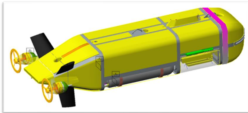
圖 12、Ifremer 自主研發的 6000 米級 AUV，能夠自主運動、下潛及通訊、支援各種各學設備，並可由船上遠端觀看探測結果。(Credit: Ifremer FOF website)
