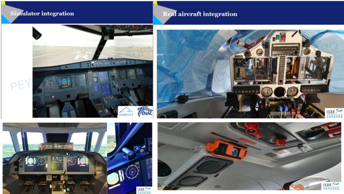
圖 3-13 眼動儀建置於飛航模擬器與航空器之實例
