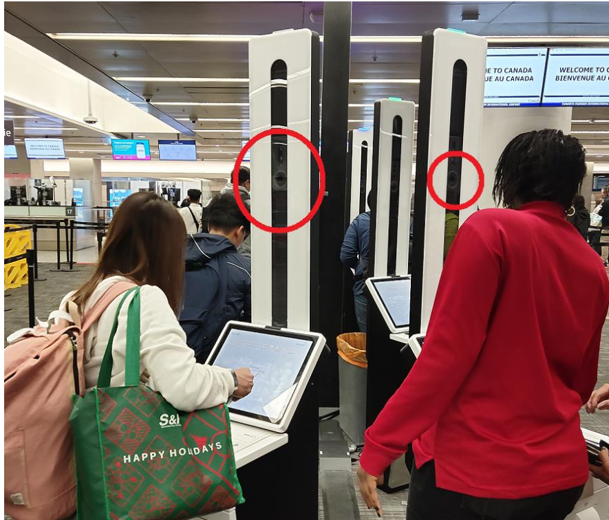
圖 35 皮爾遜機場自動通關系統攝影機會自動調整高度
