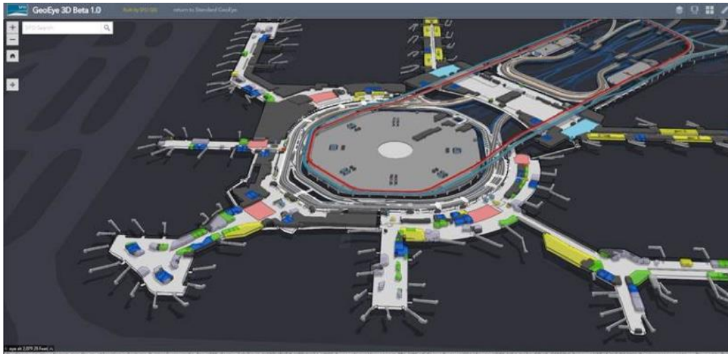
圖 12 舊金山國際機場-工作人員利用 3D 圖示查詢設施維護所需資訊
