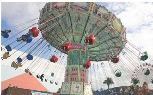
像照片一樣的旋轉鞦韆「人坐的椅子」相當於上傳縮小模型的平臺,「坐的人」相當於縮小模型。如果用驅動用馬達旋轉裝置,隨着離心力的增加,平臺會傾斜上升。如果考慮圍繞離心機旋轉軸的旋轉座標,即假設您站到平臺上並隨縮小模型一起移動,則離心力的增加(從頭到腳)與重力加速度的增加相對應,因此您可以使用縮小模型來施加等於原始尺寸的約束壓力。
