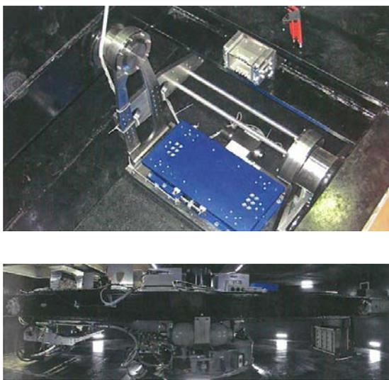
用於調查地震時土構造物及地基-構造物系統的動態行為的裝置(振動臺)，搭載在旋轉臂一端的平臺上使用。通過在振動臺上放置容納縮小模型的試樣容器，可在縮小模型的水平方向（與離心力的作用方向成直角的方向）施加振動負荷。振動負荷由液壓式伺服執行元件施加，可從觀測室使用控制用電腦控制波形等。
