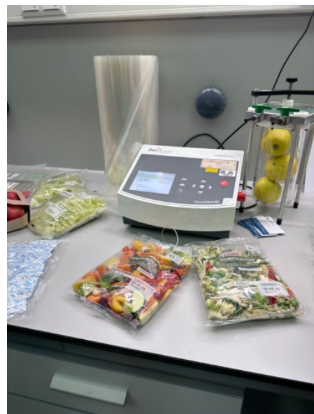
需測量包裝內的氧氣及二氧化碳，以防袋內二氧化碳太高，產品改轉為無氧呼吸，不同配方的截切蔬菜需要設置的袋子通氣性不同，需逐一檢視
