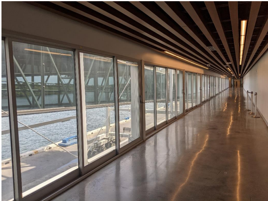
圖 180、羅德岱堡的延伸廊道內部採拉全開式門式設計，全線皆可接橋無死角
