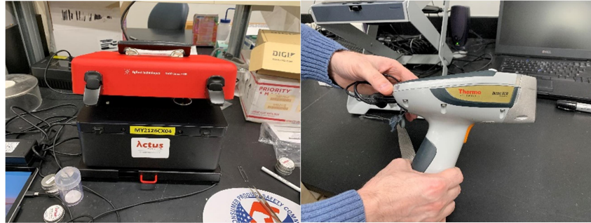
圖 16、便攜式傅立葉轉換紅外光譜儀(左)及便攜式 X 光線螢光分析儀(右)
