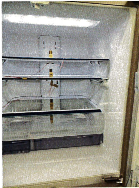
圖 10：冷藏室(含生鮮室)空氣溫度感測器設置
