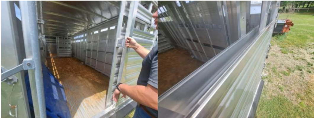
圖4.通用型動物運輸車(左圖)，可組裝分隔板進行不同物種需求的隔間。該車使用雙層鋁合金(右圖)，透過特殊壓合使鋁板結構堅硬，鋁合金可有效降低車內溫度，並且輕巧、不生鏽。
