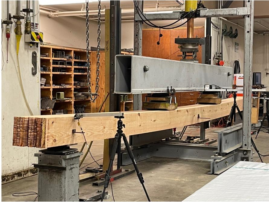
圖 23 APA 實驗室進行木梁之撓曲破壞試驗
