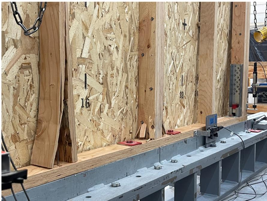
圖 22 板材之剪力破壞情形
