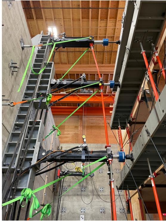
圖 7 實尺寸 3 層木構建築試驗模型以致動器施加側力
