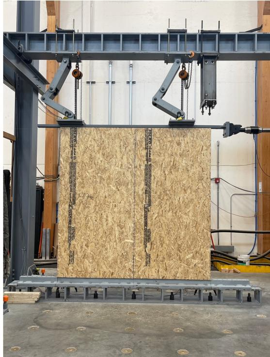
圖 21 APA 實驗室進行板材之剪力破壞試驗
