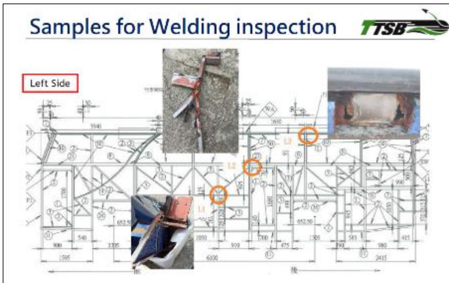
圖 3.4-2 鋼結構焊接檢測
