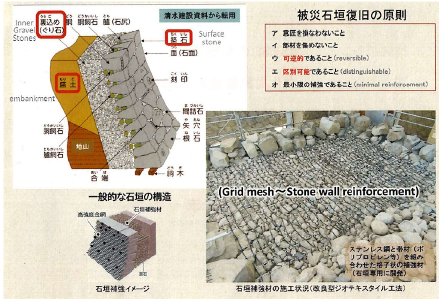
圖30 石垣的耐震補強技術
