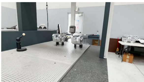
圖 3.10-6 零件 CMM 檢測 (Credit: Verticalmag.com)
